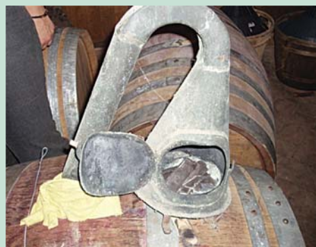
Fig. 75: Sistema tradizionale per preservare le barrique bruciando pastiglie di zolfo.
