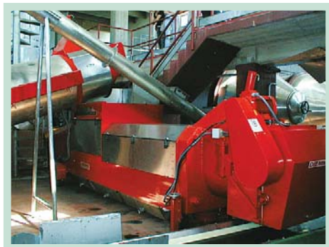
Fig. 71: Sistema di pressatura della vinaccia per vini rossi.
