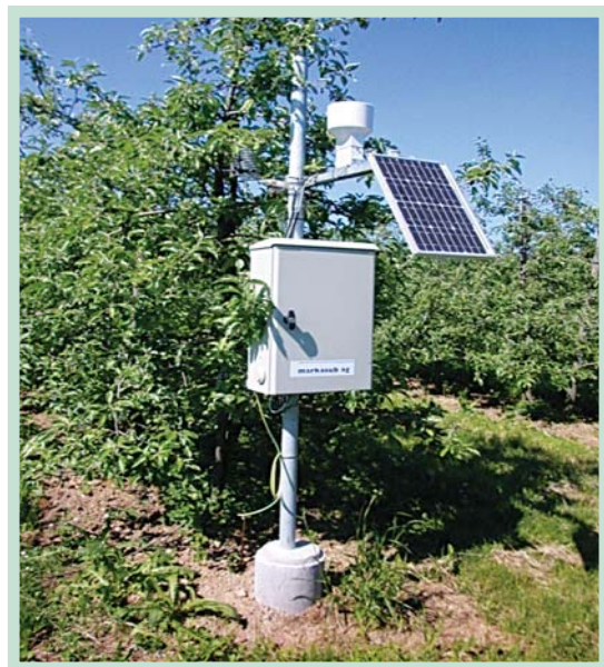
Fig. 20: La “LUFFT” stazione meteorologica che può essere utilizzata come modello per monitorare il livello di infezione di patologie fungine. 4
